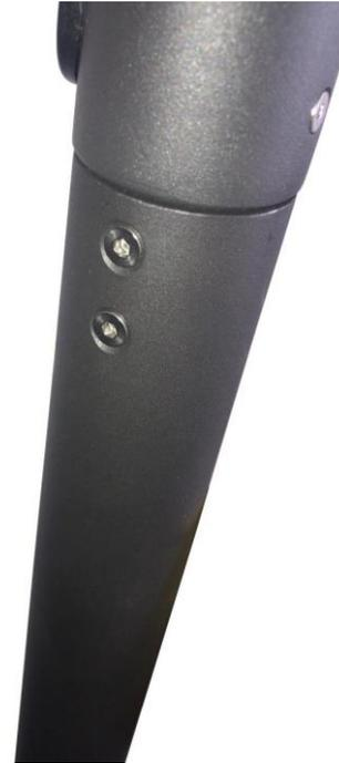
Introducir los 4 tornillos provenientes de la caja de utilidades dentro del monopatín, en ambos lados de la parte superior del mástil.
