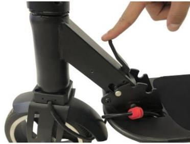
**3** Empuje hacia abajo la palanca de dirección del vehículo.
