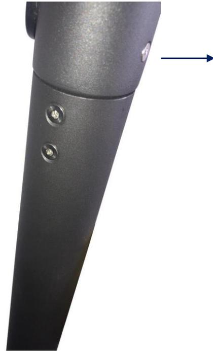
Introducir los 6 tornillos provenientes de la caja de utilidades dentro del monopatín, en ambos lados de la parte superior del mástil.
