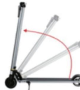
**3** Se despliega bien, después de escuchar el sonido de "clic". Significa que está bloqueado y termina el despliegue.
